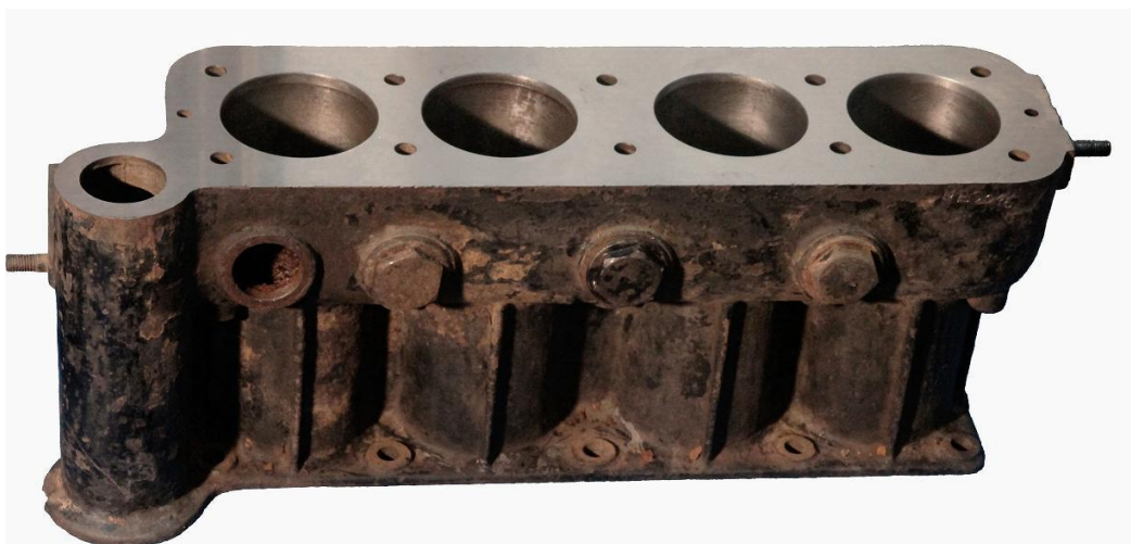
Figura 6. Bloc-motor Hispano Suiza tipus 30, de nova implantació, després de la rectificació i abans del tractament anticorrosiu de les superfícies externes. (Fotografia Ramon Blanch)
