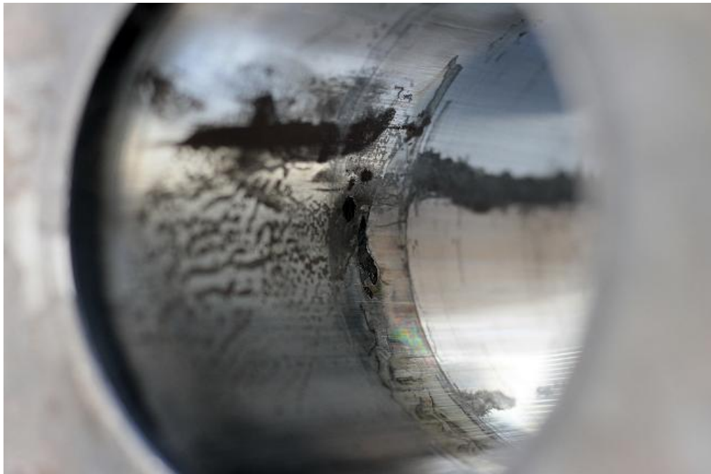
Figura 5. Fissura al primer cilindre (fotografia Ramon Blanch)
