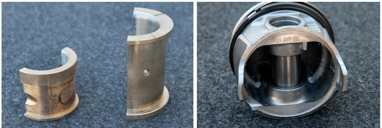
Figura 6. Siglatge amb l'acrònim NB i l'any de fabricació als coixinets del cigonyal i al joc de pistó, volandera i boló (fotografies Oscar González).
