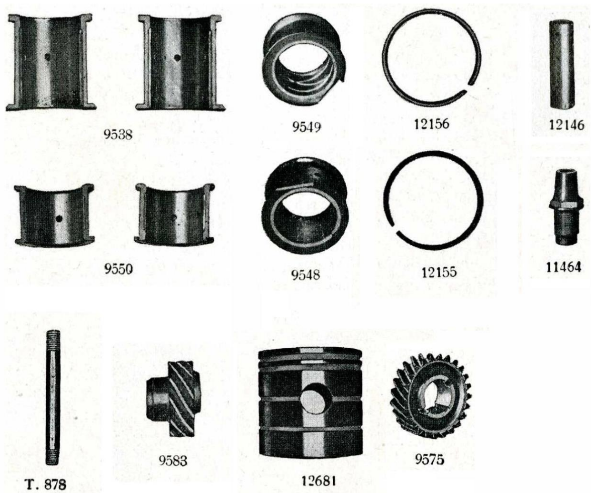
Figura 5. Referència en el catàleg original de les peces de fabricació nova, introduïdes en el nou muntatge del motor (9538 coixinet posterior del cigonyal, 9549 coixinet davanter costat cigonyal, 12156 volandera, 12146 boló o eix del pistó, 9550 coixinet central del cigonyal, 9548 coixinet davanter costat distribució, 12155 volandera de greixatge, 11464 guia de vàlvula, T.878 espàrrec per fixació de culata i cilindres, 9583 pinyó superior de l'eix vertical del comandament directe, 12681 pistó, 9575 pinyó de l'eix d'excèntriques).
