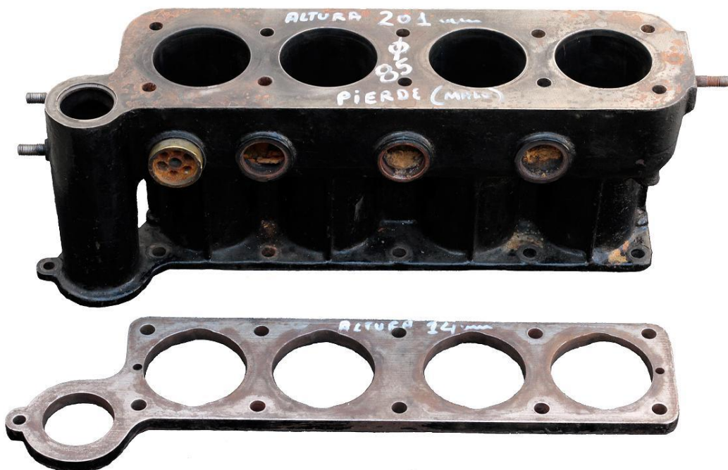
Figura 4. Bloc-motor i planxa de ferro afegida al muntatge del vehicle (fotografia Ramon Blanch)
