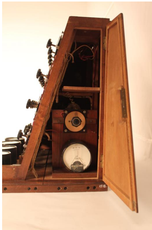
Fotografia 33: Reòstat i galvanòmetre descoberts al obrir la porta lateral.
