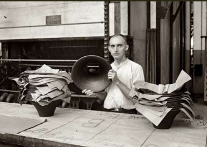
Control final del altavoz, después del acabado en horno, en la Fábrica de aparatos de radio Atwater Kent. Philadelphia, 1925. National Photo Company Collection, negativo sobre cristal. http://www.shorpy.com
