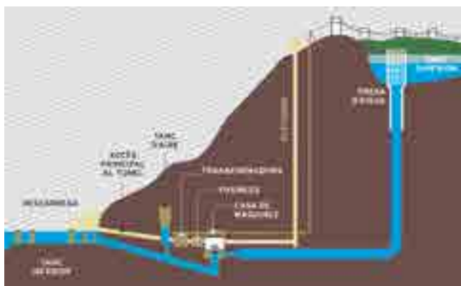
Esquema d'una central hidroelèctrica reversible en caverna
