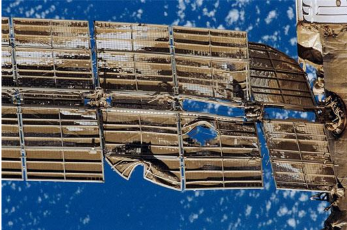
Panell solar del mòdul Spektr danyat per l'impacte amb la nau Progress. Font: Wikipedia
