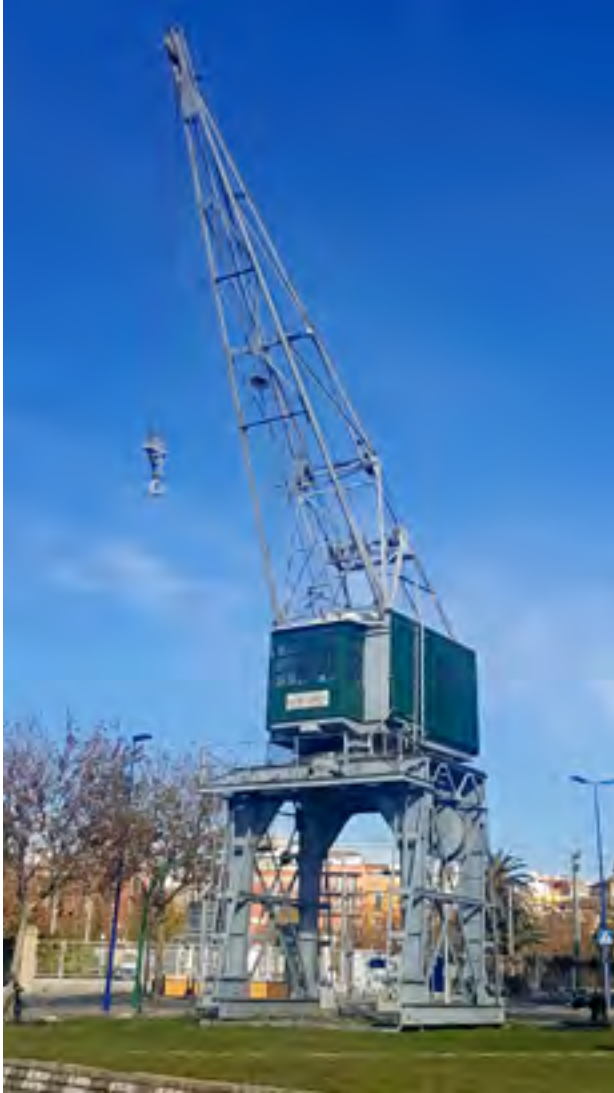
Grua pòrtic de 1,5 i 3 tones de potència, construïda als Tallers Zorroza de Bilbao. Primer tipus de grua elèctrica que va operar al Port de Tarragona, l'any 1926.
