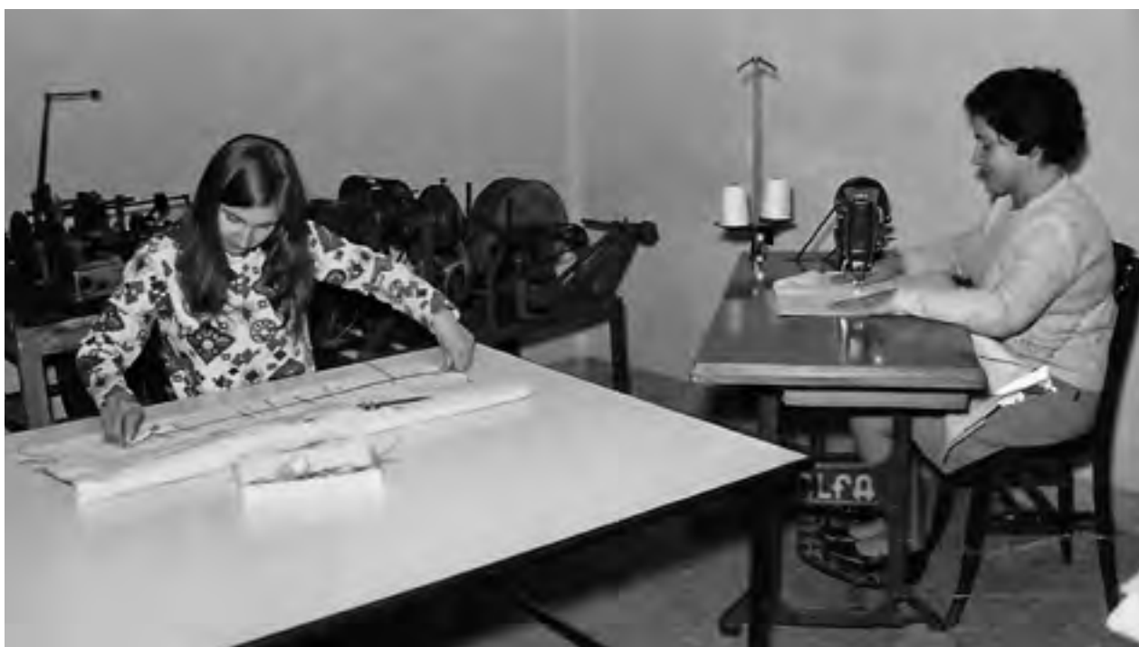
← Operàries al taller de confecció a finals dels anys seixanta. Al fons, la màquina ideada per Comella per enrotllar les resistències de níquel als cordons.
